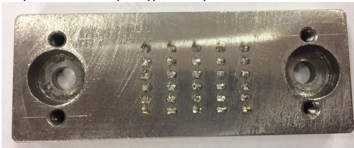
25 – сурет - Бірнеше қабатты үлгінің торы түрінде балқыту
