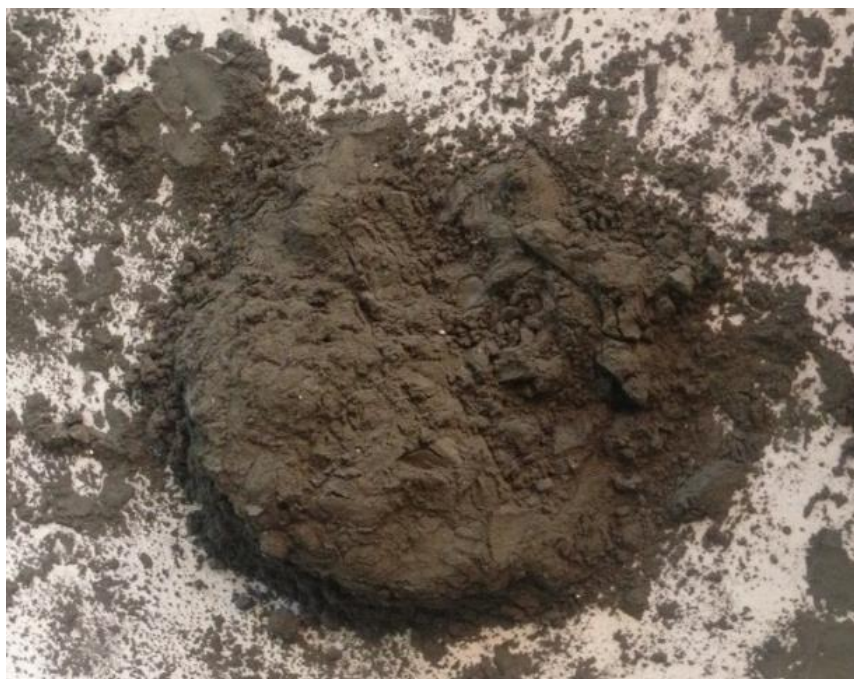
12 – сурет - Планетарлық диірмендегі МА-дан кейін Ti-Nb жүйесіндегі ұнтақ
