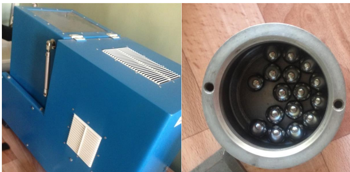
11 – сурет - А) зертханалық планетарлық қозғалатын орталықтан тепкіш машина; Б) барабандағы тегістеуіш денелер (болат шарлар);
